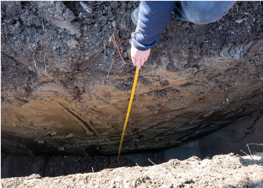
Figur 4. Provgrop 1, ca 2,5 m djup. Provgropens läge är i lertäkten i den djupaste delen. Fet lera.
